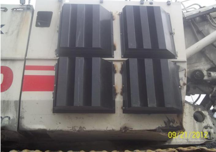
**Réduction du bruit : Bennes des camions de halage 703F recouvertes de caoutchouc**
